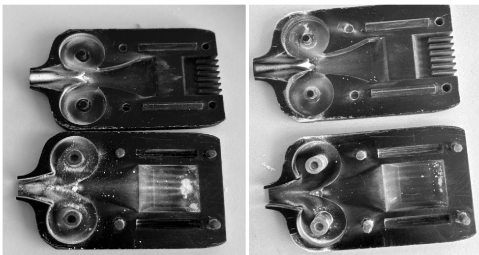
Рис. 1. Результаты экспериментов: образец №2 без добавления носителя (слева); образец №2 с 2% InhaLac® 120 (справа)
