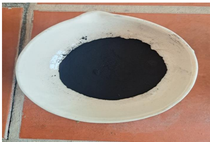
Рис. 1. Внешний вид твёрдого углеродистого остатка, полученного после пиролиза отработанных шин
