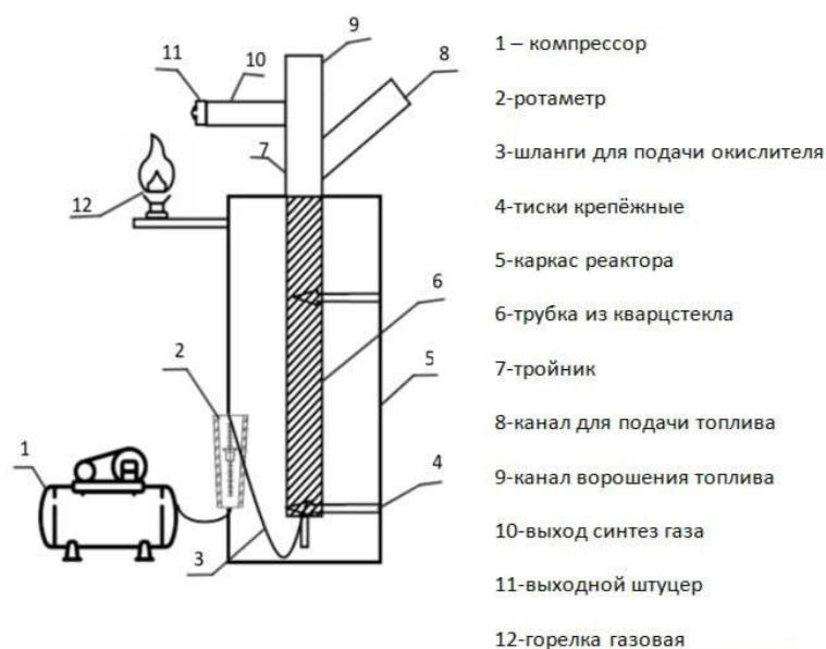
Рис. 1. Схема лабораторной установки газификации отходов
